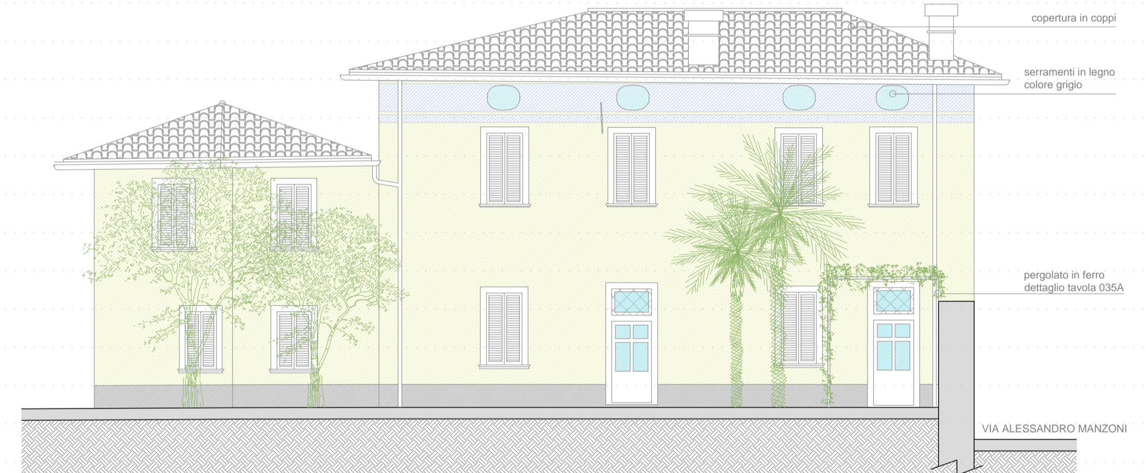
PROSPETTO OVEST SCALA 1:100
