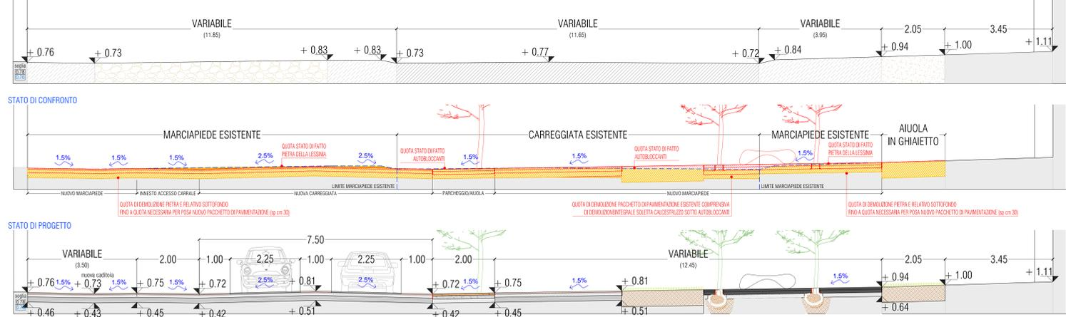
**SEZIONE 9 - (carreggiata stradale asfalto - boschetto - banca) - scala 1:50**
