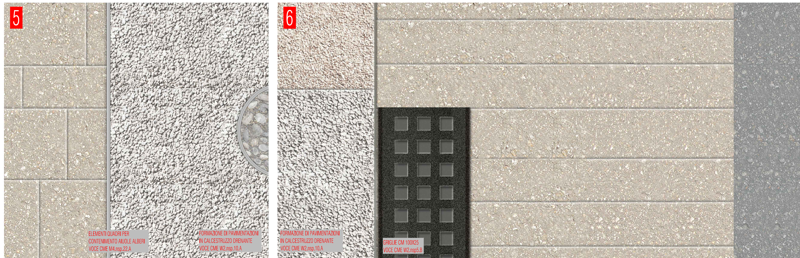
DETTAGLI PAVIMENTAZIONI IN ASFALTO STAMPATO E RESINATO E IN CALCESTRUZZO DRENANTE scala 1:5
