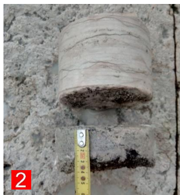
1 - Carotaggio 1: tratto iniziale di via Rocca 2 – Carotaggio 2: lastricato carrale via Mazzini 3 - Carotaggio 3: sede stradale via Rocca
