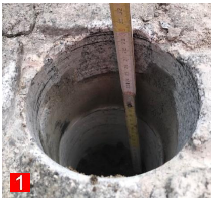
1 - Carotaggio 1: tratto iniziale di via Rocca 2 – Carotaggio 2: lastricato carrale via Mazzini 3 - Carotaggio 3: sede stradale via Rocca
