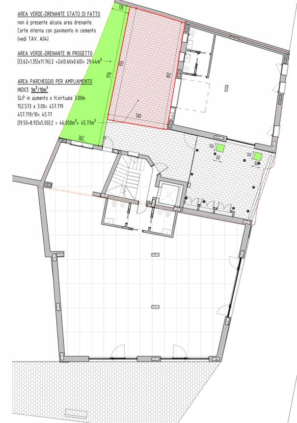
4 PIANTA PIANO TERRA - DIMOSTRAZIONE AREA DRENANTE E PARCHEGGIO, 1 : 100
